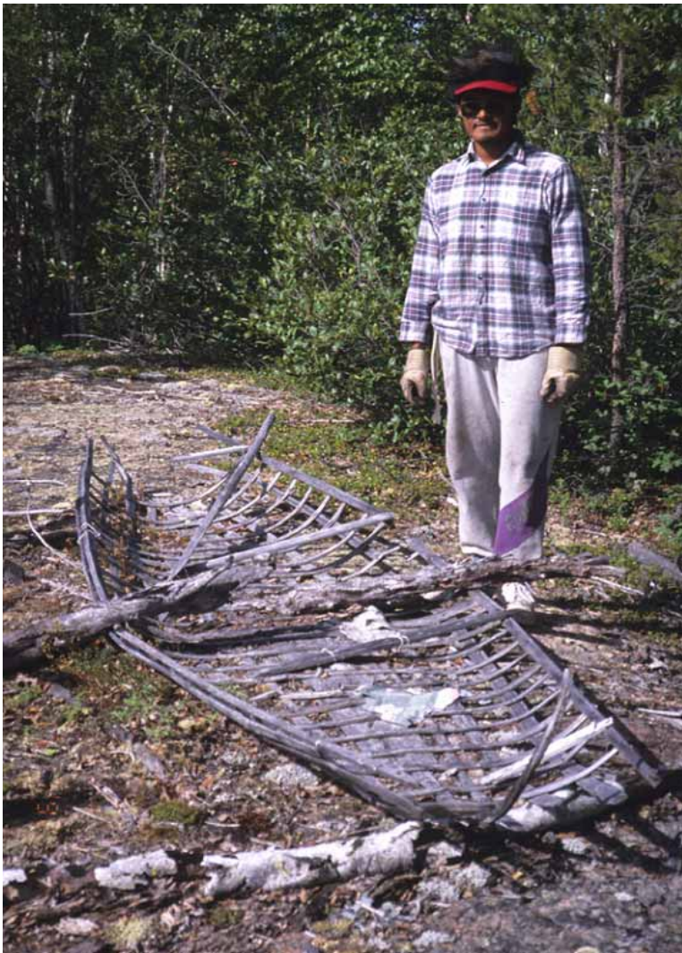
Technicien itinérant se tenant à côté de la charpente d'un canot de cèdre (et de ce qui reste de son canevas) près de la rivière Camsell.
